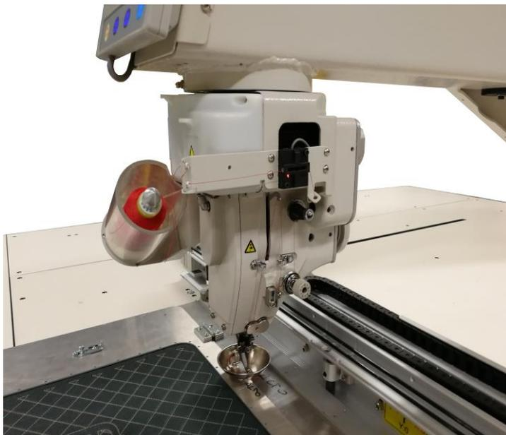
La speciale testa rotante è stata progettata per garantire la stessa qualità di punto in ogni direzione. È particolarmente adatta alle produzioni con tolleranza 0 per punti irregolari. Il blocco rotante è dotato di portarocchetto e sensore di rottura filo. La macchina è dotata di uno speciale sportello sul piano che permette la sostituzione rapida e semplice della spolina.
